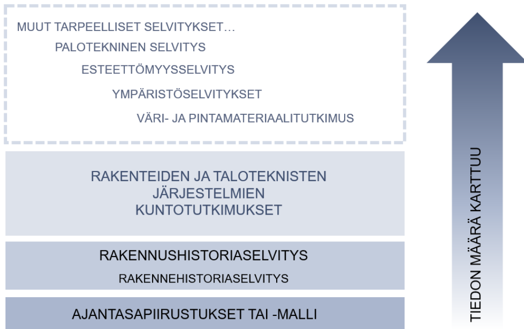
Kuva 15. Ajantasapiirustukset tai -malli yhdessä rakennushistoriaselvityksen kanssa muodostavat perustan muille selvityksille ja tutkimuksille. Kaavio AFRY Finland Oy.
