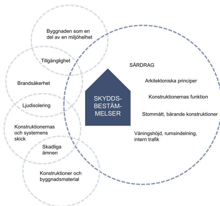
Bild 5. Egenskaper som ska utredas och identifieras som utgångsuppgifter för ett reparations- eller ändringsprojekt. Här är skyddsbestämmelserna centrala. Diagram AFRY Finland Oy.
