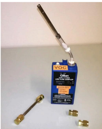
Kuva 26. Sisäilman VOC-näytteen keräys pumppuun kytketyllä adsorbenttikeräimellä (YO2016).
