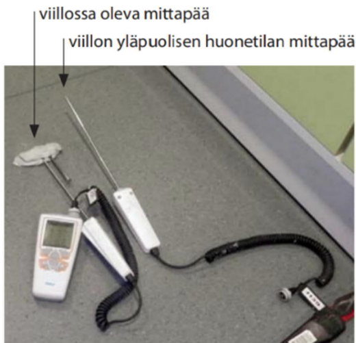
Kuva 23. Viiltomittaus käynnissä muovimaton alta (RT 103333).
