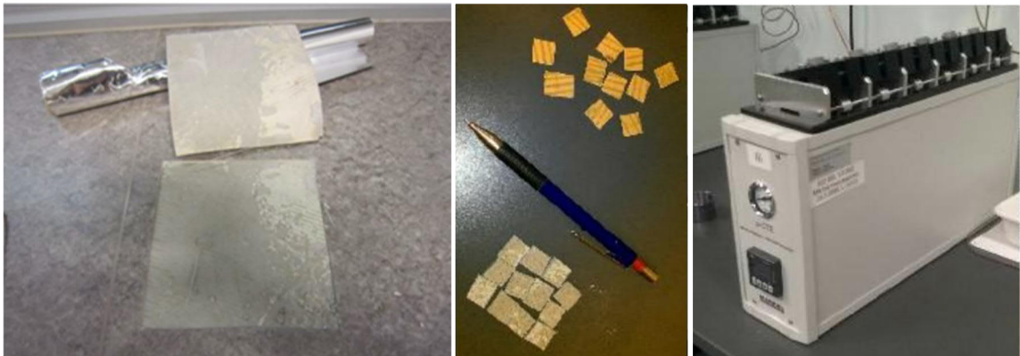
Kuva 28. Bulk-mittauksessa materiaali suljetaan näytteenoton jälkeen tiiviisti alumiinifolioon ja toimitetaan ilman suuria lämpötilavaihteluja (yleensä kylmälaukussa) laboratorioon. Keskellä kuva pilkotusta materiaalista ennen mikrokammioon sulkemista ja oikealla kuva mikrokammioilaitteistosta. (Lähde: Vahasen kuva-arkisto).
