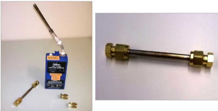
Kuva S.6.3. Sisäilman VOC-näytteen keräys pumppuun kytketyllä adsorbenttikeräimellä. Oikeanpuoleisessa kuvassa päistä suljettu Tenax-TA -adsorbenttiputki. (Ympäristöopas 2016, 69. Alkuperäinen kuvan lähde: Mikrobioni Oy.)
